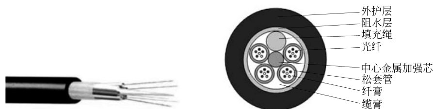
图 1-1 光缆结构
