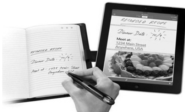
图 3-7 写在数字纸上的墨水笔画,其数据被无线传输给计算机
