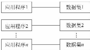
图 1-1 人工管理阶段程序与数据之间的关系
