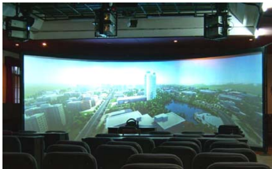
图 1.15 环幕投影式虚拟现实系统
