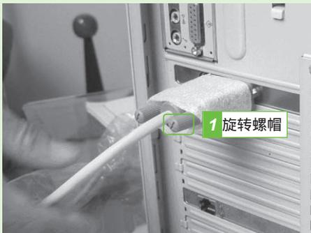
图1-17 连接显示器
