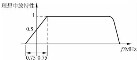
图 3.5.8 接收中频残留边带滤波器频率特性
