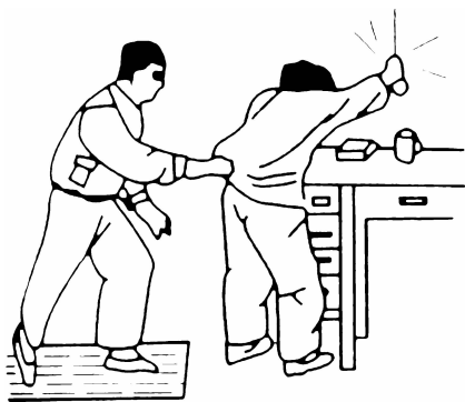
图 1-6 将触电者拽离电源
