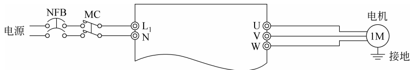
图 3-8 单相 200V 电源输入端子接线图
