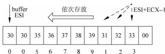
图 3.12 ASCII 码串的存储示意图
