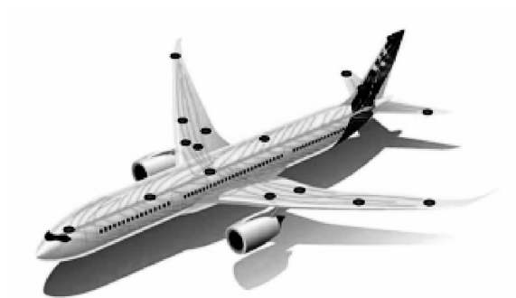
图 1-2 飞机的机身内外布置的传感器
