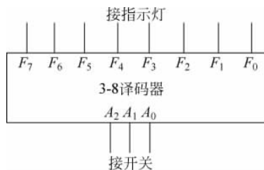
图 5.4.2 3-8 译码器电路示意图
