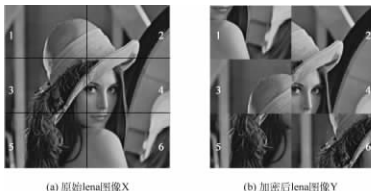
图 3-1 简单换位式加密算法示意图
