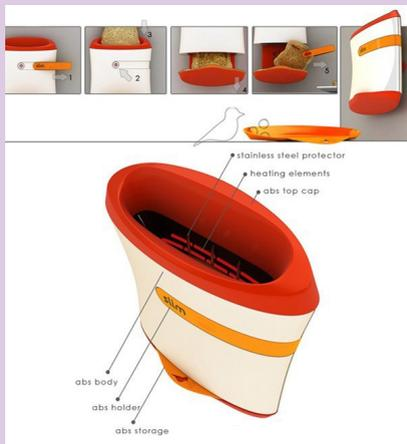
图2-2 面包机的设计2
