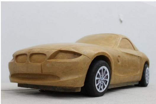
图2-21 硬油泥汽车模型
