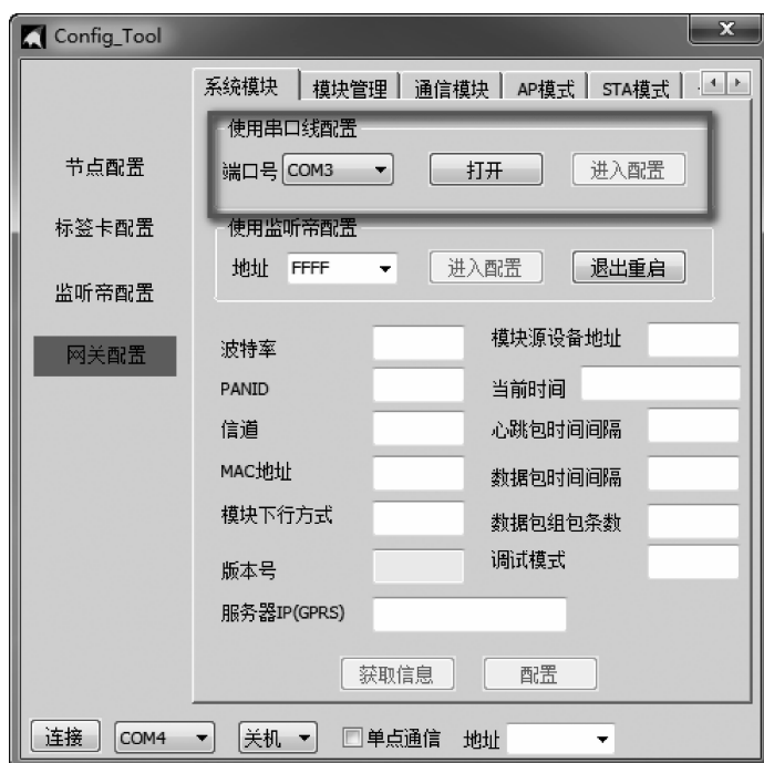
图 1.33 “系统模块”配置
