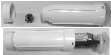
图 1.6 传感器的具体结构图
