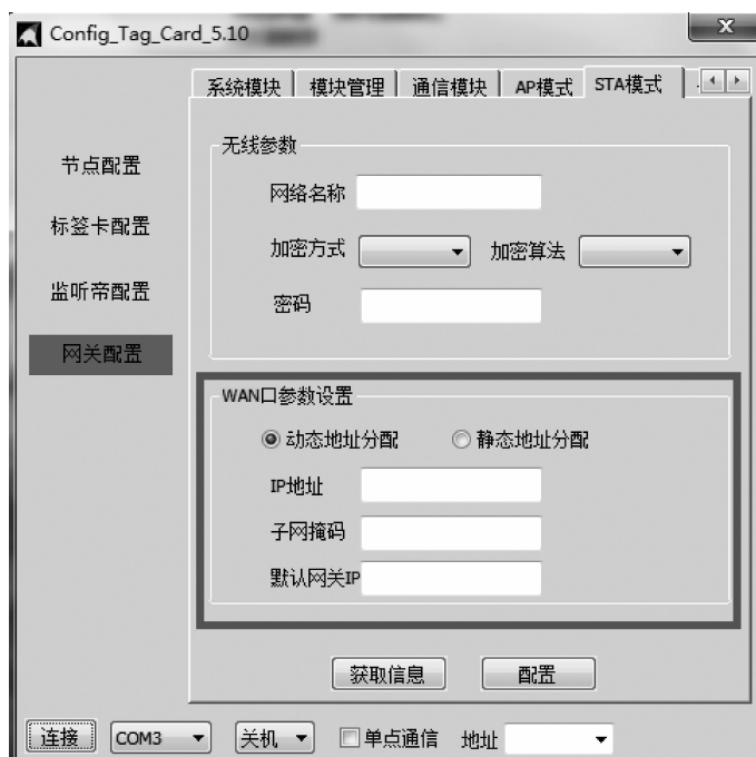
图 1.34 “STA 模式”参数配置
