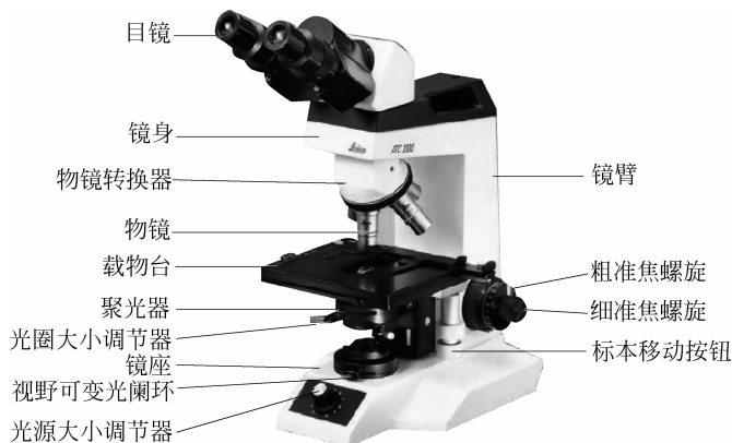
图 1-7 普通光学显微镜的构造
