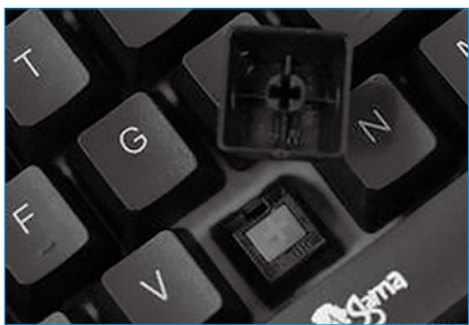
图1-40 机械键盘按键开关
