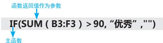
图2-3 嵌套函数示意图
