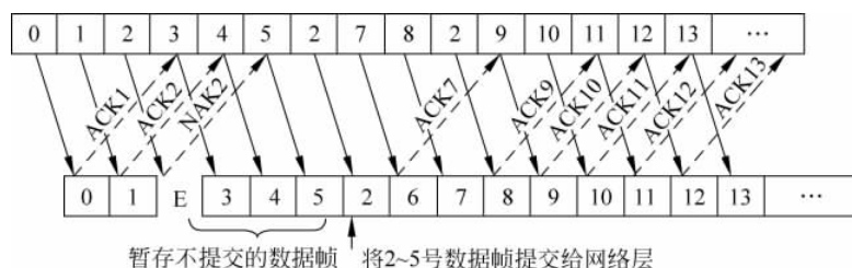
图 3-17 选择重传 ARQ 协议的工作过程
