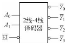
图 3.24 2 线-4 线译码器逻辑符号
