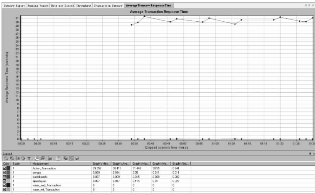
图 5-97 300 人测试中 Average Transaction Response Time 图
