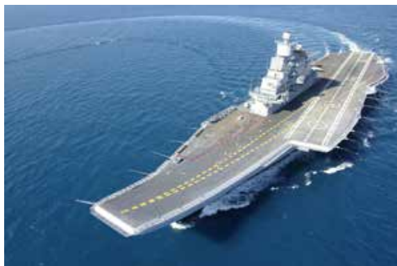
采用斜角甲板和“滑跳”甲板的印度“维兰玛迪雅”号航空母舰
