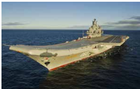
采用斜角甲板和“滑跳”甲板的俄罗斯“库兹涅佐夫”号航空母舰
