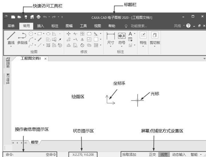
图 1-1 CAXA CAD 电子图板最新风格的用户界面
