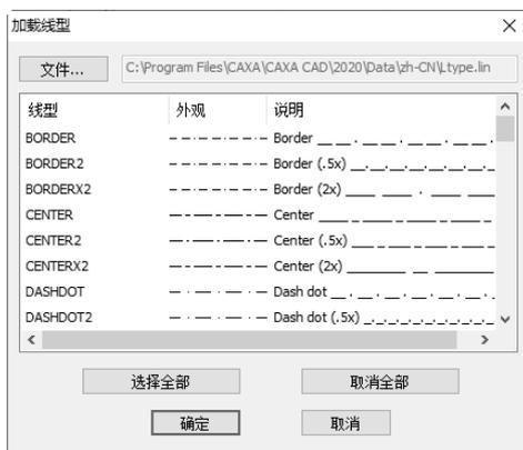
图 2-13 “加载线型”对话框
