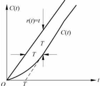
图 3-3-5 一阶系统的斜坡响应曲线
