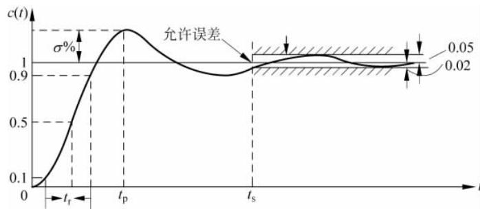
图 3-2-2 控制系统的单位阶跃响应曲线
