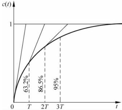
图 3-3-3 一阶系统的单位阶跃响应曲线
