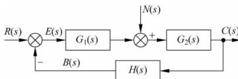
图 3-7-1 扰动输入作用下的系统结构图
