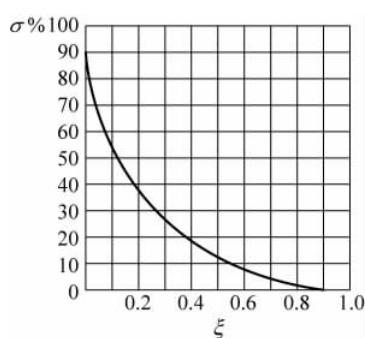
图 3-4-2 超调量  $\sigma\%$  和  $\xi$  的关系曲线
