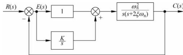
图 3-6-4 系统结构图
