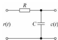
图 3-3-1 RC 滤波电路
