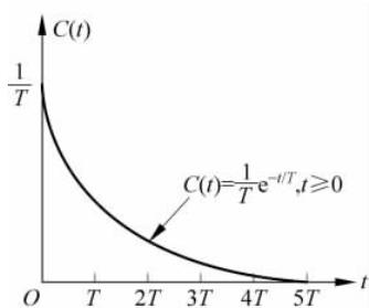
图 3-3-4 一阶系统的脉冲响应曲线
