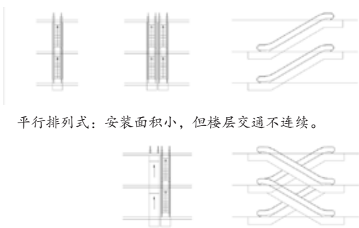
交叉排列式：乘客流动升降两方面均为连接，且远离搭乘场，升降流动不发生混乱，安装面积小。
