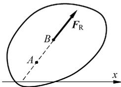
图 3.3.1 平面一般力系二矩式的平衡方程说明
