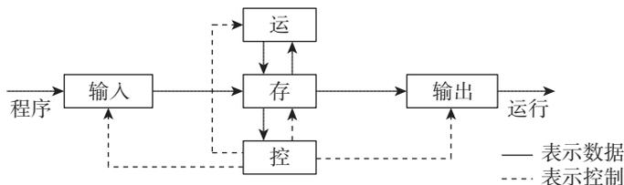
图 1-3 计算机的工作原理
