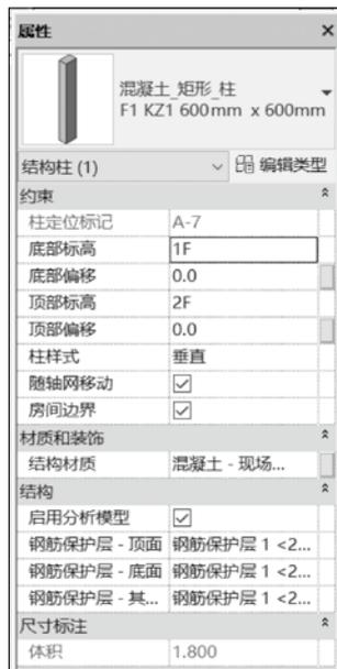
图 3.1.10 结构柱实例属性
