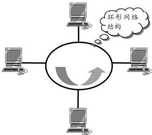
在环形拓扑结构中，数据的传输路径是连续的，没有逻辑的起点与终点，因此也没有终结器。工作站和文件服务器在环的周围各点上相连。当数据传输到环时，将沿着环从一个节点流向另一个节点，找到其目标，然后继续传输，又回到始发节点。
