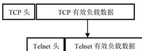
Telnet 在发送端和接收端使用 TCP 的 23 号端口进行专用的通信。Telnet 包含许多通信选项，如 7 位或 8 位兼容、不同终端模式的使用、发送端和接收端的字符回应、同步通信、字符流或单独字符的传输以及流控制等。
