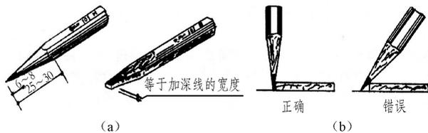
图1-8 绘图铅笔的削法及使用方法
