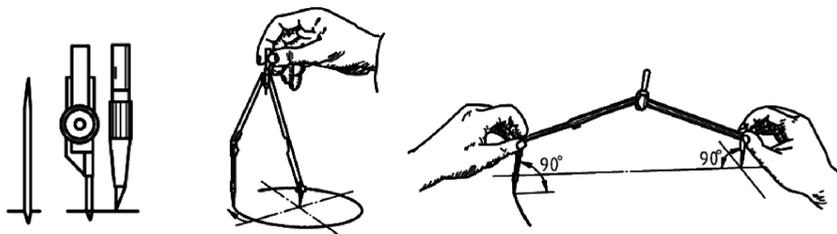
图1-5 圆规使用方法
