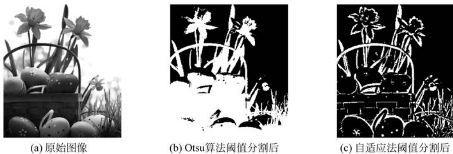
图 5.25 Otsu 算法和自适应法阈值分割效果对比
