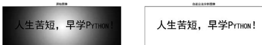
图 5.7 自适应法阈值分割效果
