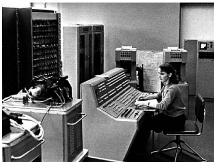
图 1-6 操作员在没有 CRT 显示器的人机界面操作台上操作 [25]
