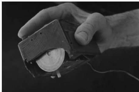
图 1-9 Douglas Engelbart 发明的世界上第一个鼠标器 [29]
