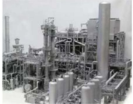
(b) 3D 打印工厂油罐区模型
