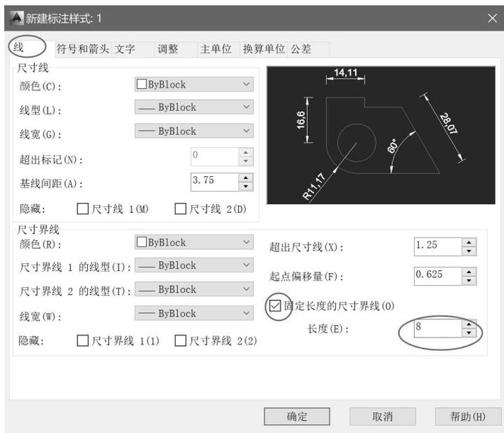
图 1-22 标注样式中线设置
