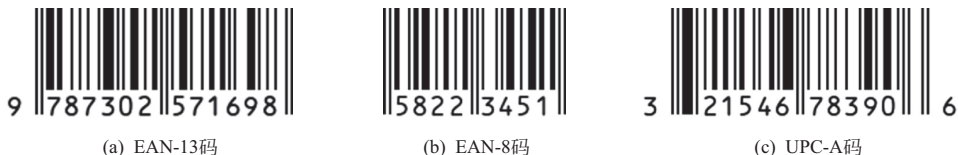
图 1-1-3 几种常用的一维条码样图
