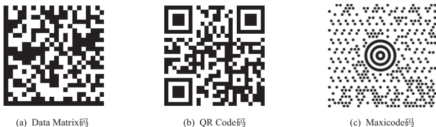
图 1-1-5 几种常用的二维条码样图
