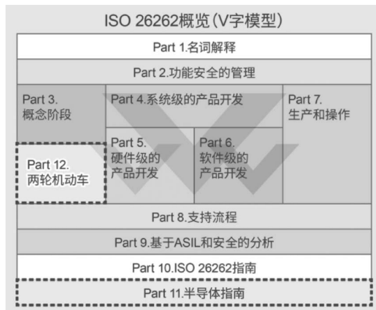
图 3-10 ISO 26262 对产品开发各阶段的参考流程模型
