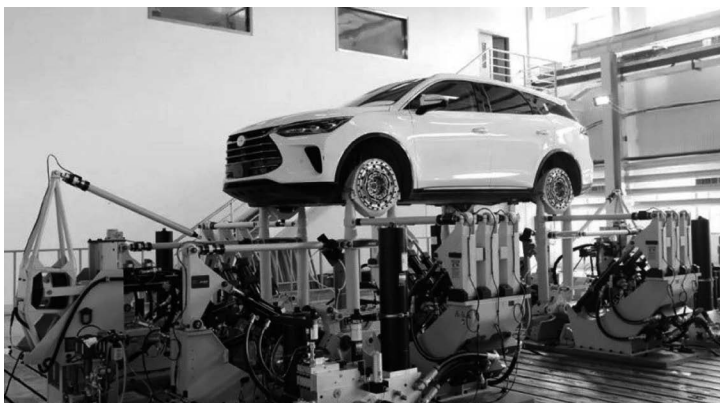
图 3-6 比亚迪汽车工程研究院研发的 24 通道轴耦合模拟试验台
