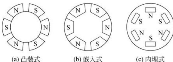
图 3-12 PMSM 转子的 3 种结构形式
