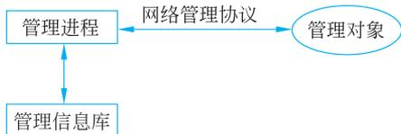
图 3-1 网络管理系统的逻辑架构
