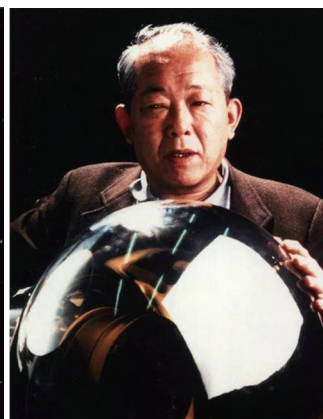
图 1.7 20 英寸光电倍增管
