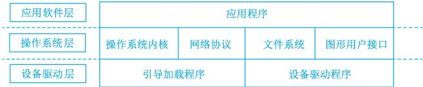
图 1-3 带操作系统的嵌入式软件的体系结构
