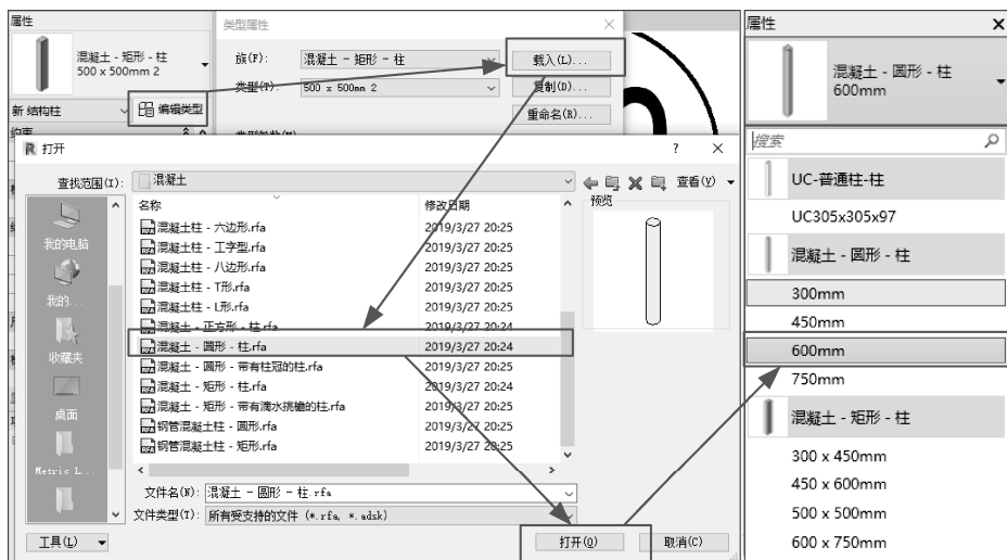
图 2-31 载入混凝土圆形柱
