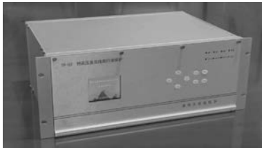
图 1-2 特高压输电线路数字式行波差动保护装置实物图
