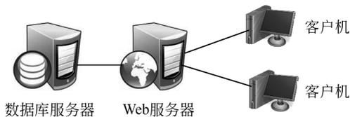
图 1-8 B/S 结构示意图
