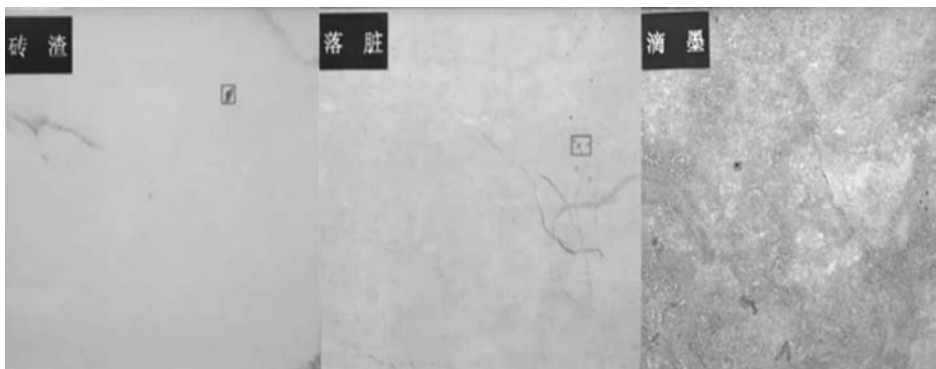
图 3-1-2 瓷砖瑕疵示例
