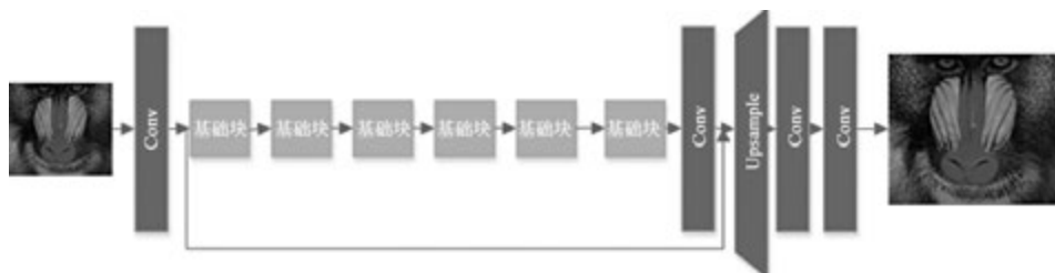
图 4-7 ESRGAN 使用的生成网络的结构
