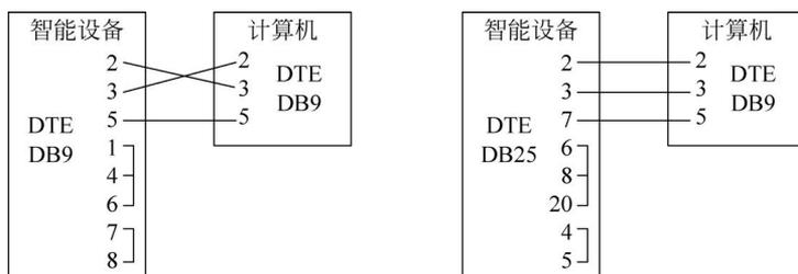
图 5-3 RS232 自握手的接线方式
