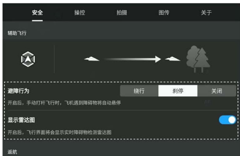
图2-3 选择“刹停”的避障行为，并开启“显示雷达图”功能
