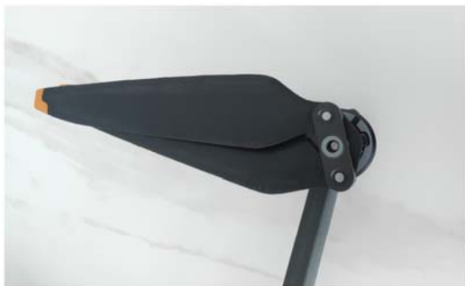
图1-17 将桨帽对准电机桨座上的孔
