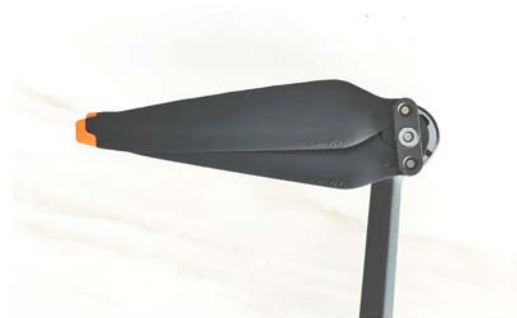
图1-18 螺旋桨将弹起锁紧
