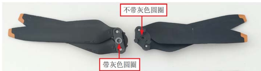
图1-14 带灰色圆圈标记和不带灰色圆圈标记的螺旋桨
