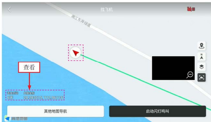
图2-8 查看飞行器最后降落的位置和失联坐标
