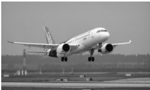
图 1-3 前三点式起落架布局的飞机 [3]
