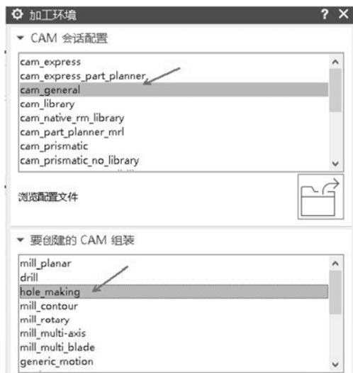
图 3-87 设置 hole-making 加工
