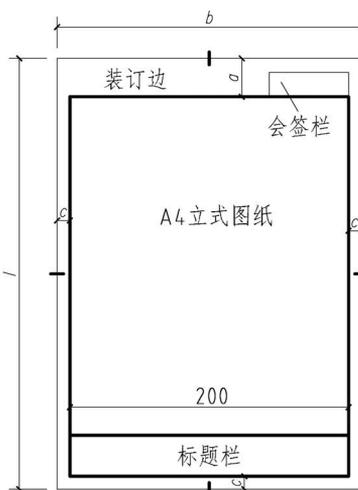
图 1-3 A0~A3、A4 立式图纸样式
