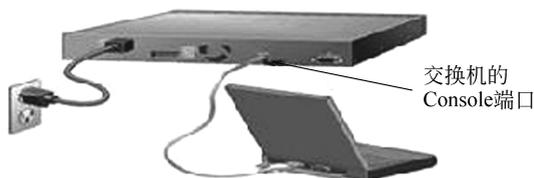
图 1-8 设备连接图
